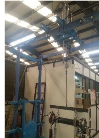
Figure 1. (a) Sección del ducto a instrumentar, (b) Parche de Monitoreo, (c) Esquema del ducto con el parche, (d) Tubería piloto del II-UNAM y (d) Pruebas de carga a la sección del ducto instrumentado.
