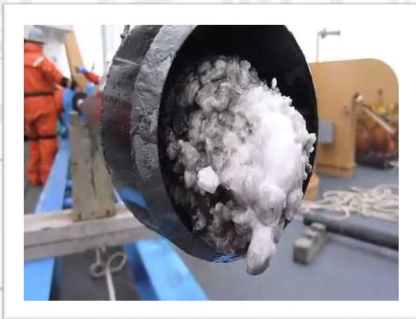
Tubería bloqueada con alfastenos y cera.
