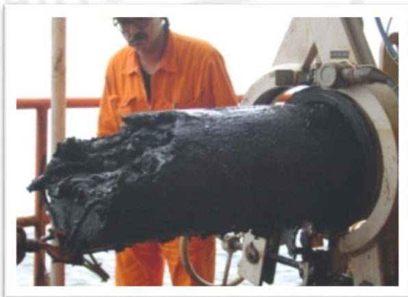
Tubería bloqueada con alfastenos y cera.
