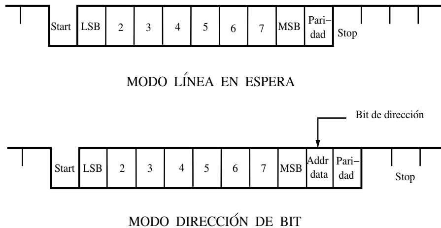
Figura 9.2. Formato de bits la interfaz SCI
