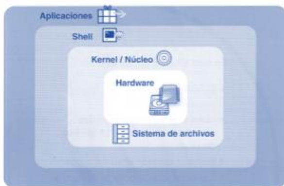
Figura 1: Capas que componen al sistema operativo GNU/Linux.
