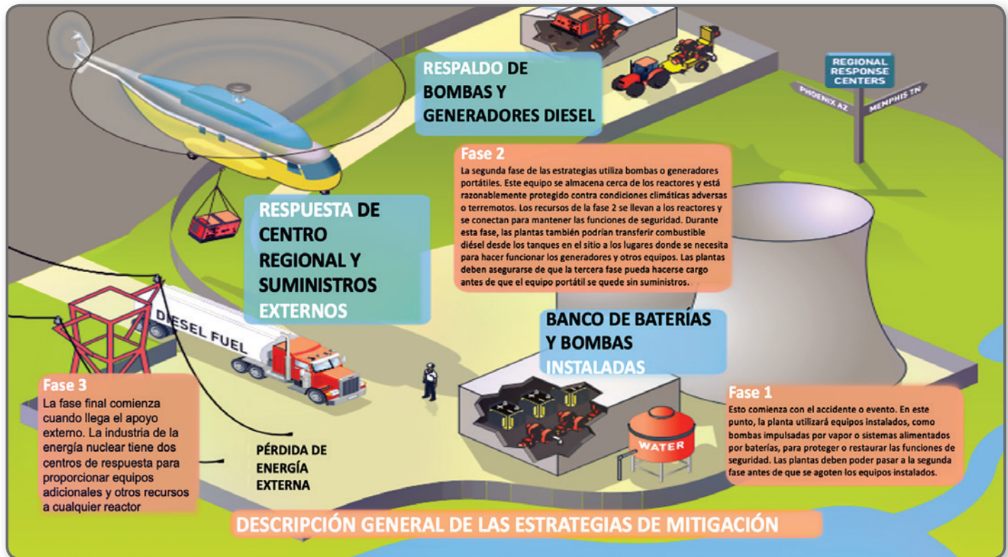
Figura 8. Estrategia de mitigación de accidente. FLEX: equipos portátiles autónomos (diésel) aerotransportables que garantizan el suministro eléctrico y de agua de refrigeración a diferentes presiones desde el exterior de los edificios en caso de pérdida de los sistemas fijos durante un accidente. 8
