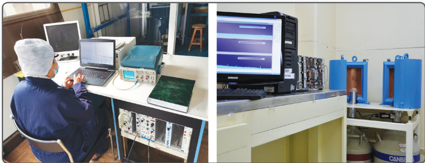
Figura 2. Izquierda el sistema caracterizador de desechos, y a la derecha parte del equipamiento de espectrometría gamma del laboratorio de desechos
